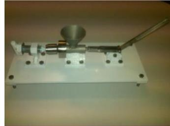
**Figura 12** Ensamble de la inyectora/extrusora
