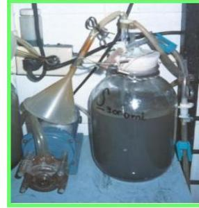
**Figura 2** Reactor Inoculador anaerobio
